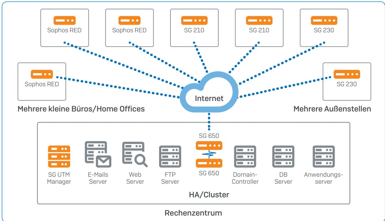
Bereitstellungsszenario mit einem Cluster aus zwei SG 650 Appliances als Teil eines weitverzweigten Großunternehmens mit Sophos REDs zum Schutz von kleinen Büros und Home Offices sowie weiteren SG Appliances zum Schutz von Außenstellen. Zur Unterstützung von HA sind Appliances desselben Modells UND mit derselben Revisionsnummer erforderlich
