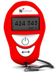
Das zeitbasierte Authpoint-Hardware-Token mit Einmalkennwort (One-Time Password, OTP) ist ein abgedichtetes elektronisches Gerät, das alle 30 Sekunden sichere OTPs generiert. Unternehmen können es als Alternative zu Mobilgerät-Token verwenden, um sich für geschützte Ressourcen zu authentifizieren.
